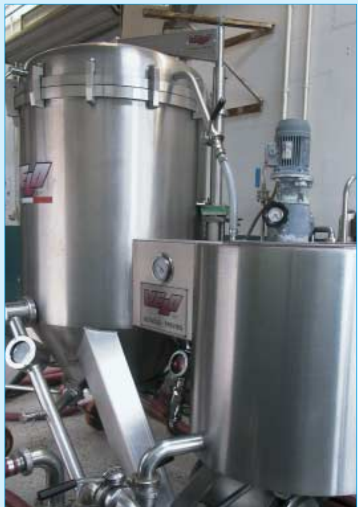
In deze filters wordt de aangevoerde wijn een eerste maal voorgefilterd.
